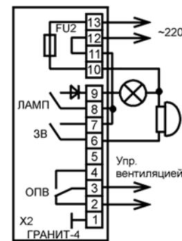
Рис 3. Подключение лампы, сирены, табло с питанием 12 В
