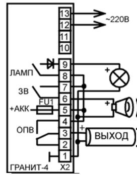
Рис 4. Подключение пассивных пожарных извещателей
