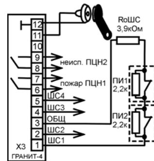
Рис 5. Подключение токопотребляющих пожарных извещателей
