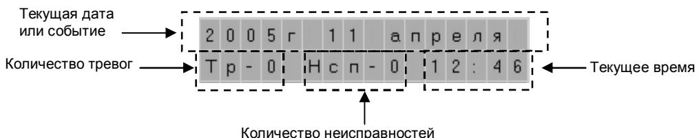
Рис. 3 Вид дисплея в дежурном режиме (состояние прибора)
