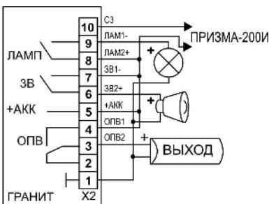
**Рис. 6** Подключение токопотребляющих пожарных извещателей
