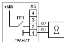
**Рис. 5** Подключение пассивных пожарных извещателей
