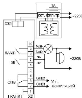
**Рис. 4** Подключение электромагнитного замка
