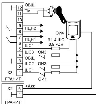
**Рис. 3** Подключение лампы, «ПРИЗМА-200И», сирены, табло с питанием 12В
