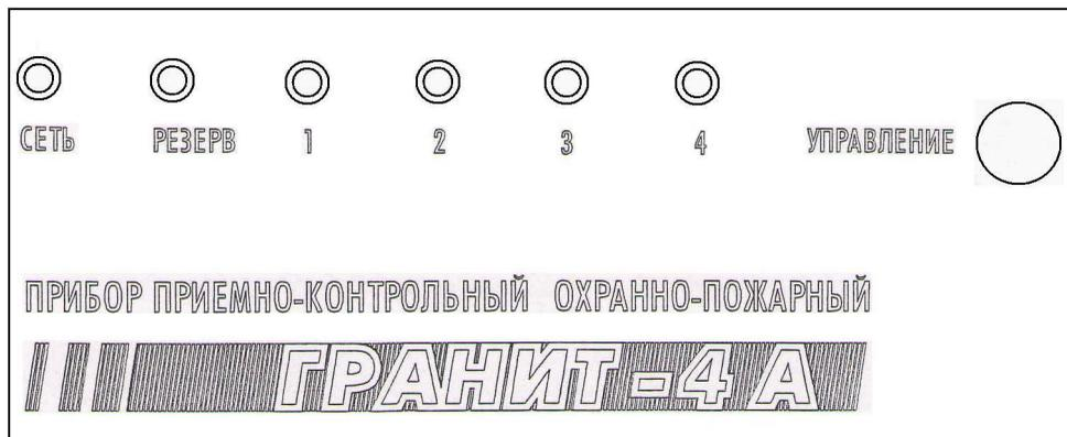
Внешний вид панелей индикации и управления приборов Гранит-2А и Гранит-4А
