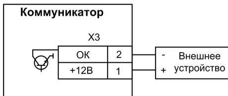
Схема подключения внешнего устройства к коммуникатору
