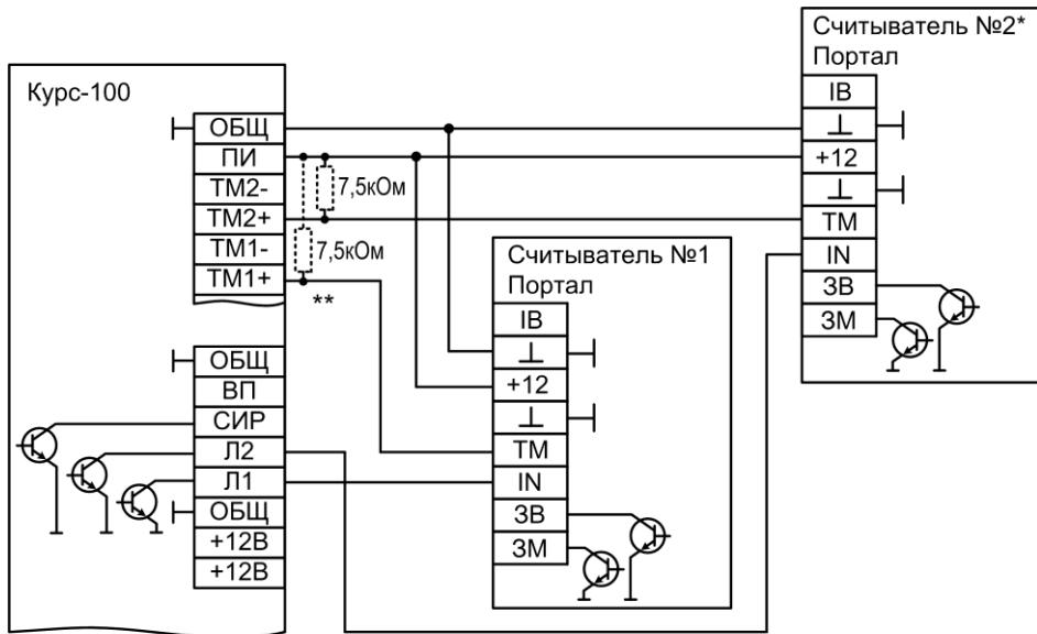
Рисунок 15 – Схема подключения считывателей «Портал» к контроллеру
