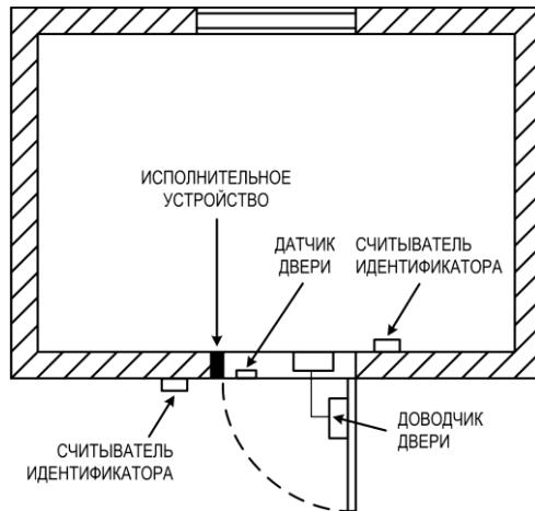
Рисунок 3 – Пункт прохода с контролем входа/выхода
