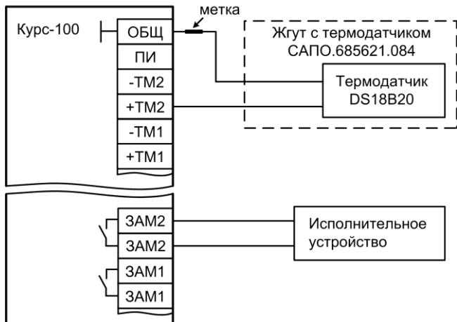
Рисунок 14 – Схема подключения жгута с термодатчиком
