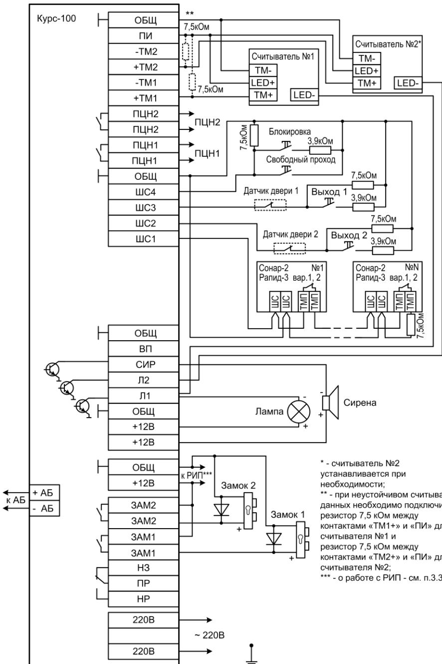
Рисунок 8 – Схема внешних подключений к контроллеру при конфигурации
