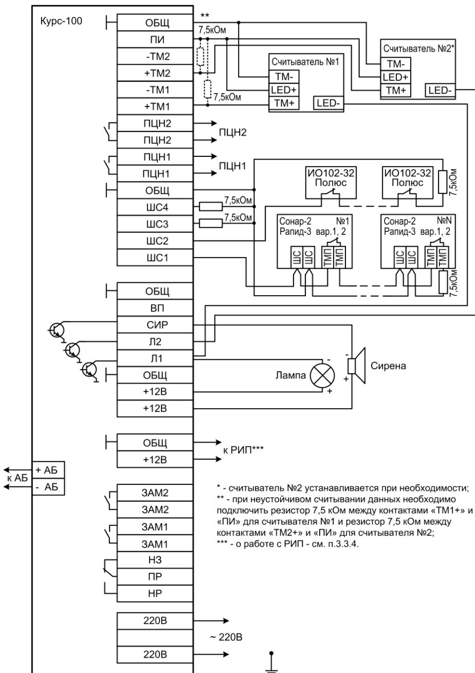
Рисунок 6 – Схема внешних подключений к контроллеру при конфигурации «2WS»
