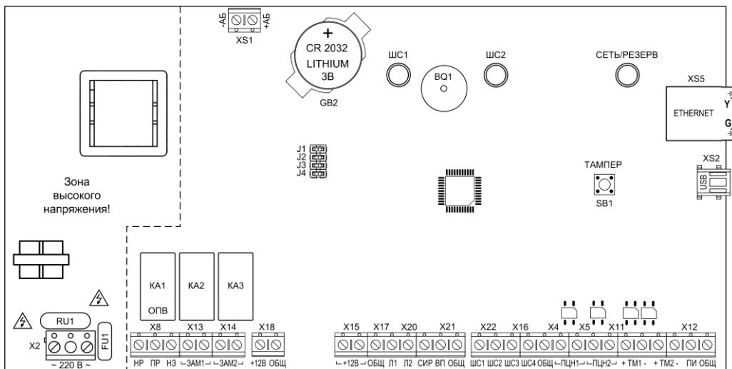
Рисунок 1 – Плата контроллера «Курс-100», вариант 1
