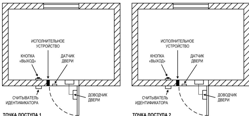
Рисунок 2 – Пункты прохода с контролем входа
