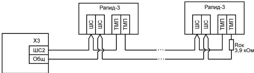
**Рис. 3** Схема подключения нескольких охранных извещателей с питанием по шлейфу «Рапид-3» к прибору «Гранит»
