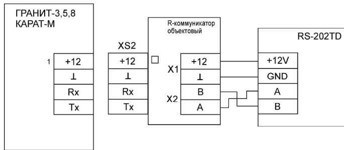
Рис. 10 Схема соединения прибора с R-коммуникатором и передатчиком
