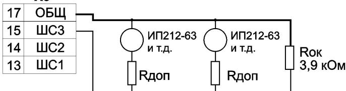
Рис. 1-А Схема соединения прибора «Гранит-3» с внешними устройствами
