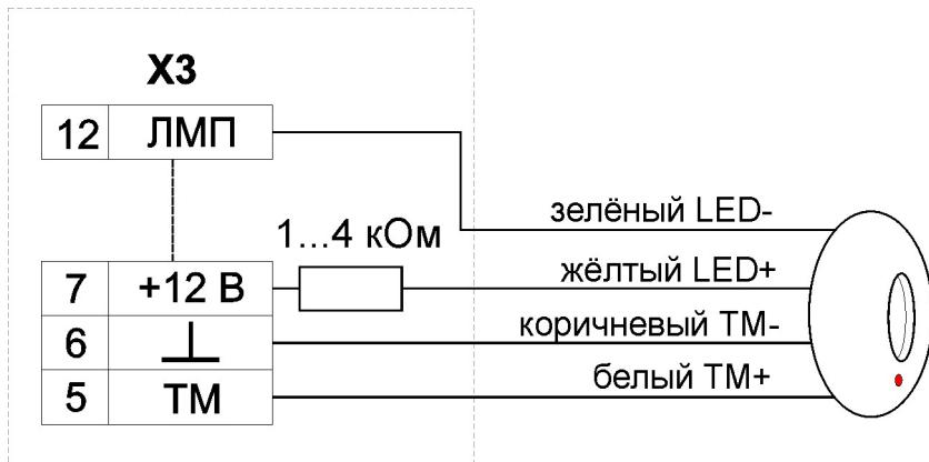
**Рис. 4** Схема подключения порта TM к прибору «Гранит»
