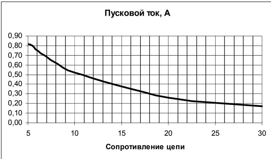
Таким образом, для модулей пожаротушения 0.7 А следует выбирать оборудование включенное в цепь так чтобы общее сопротивление внешней цепи находилось в пределах 5 – 5,5 Ом.
