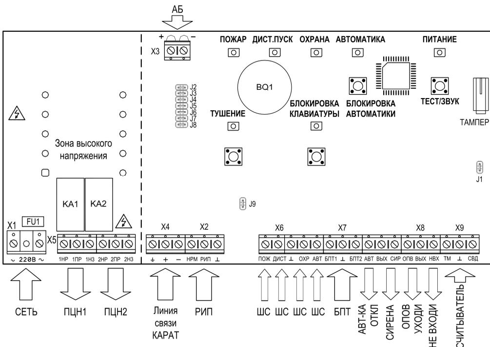
**Рис. 2 Плата контроллера**
