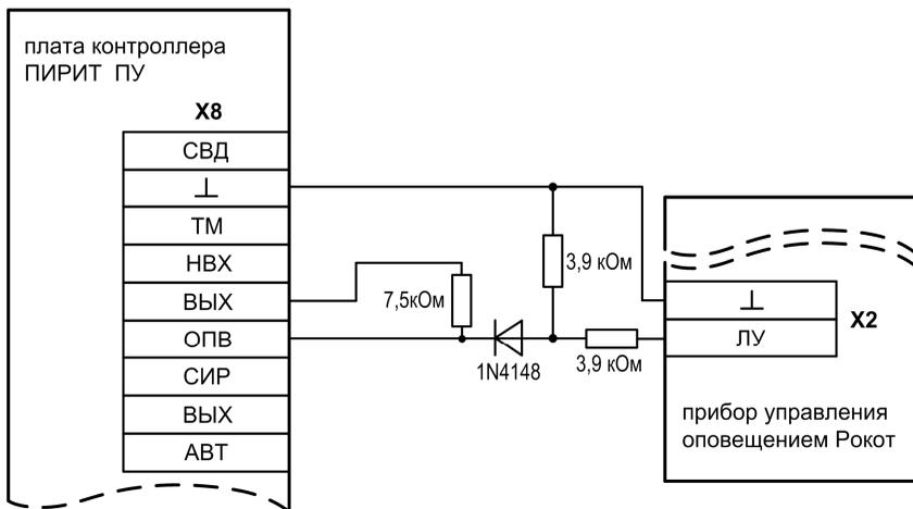
**Рис. 7** Подключение прибора речевого оповещения РОКОТ
