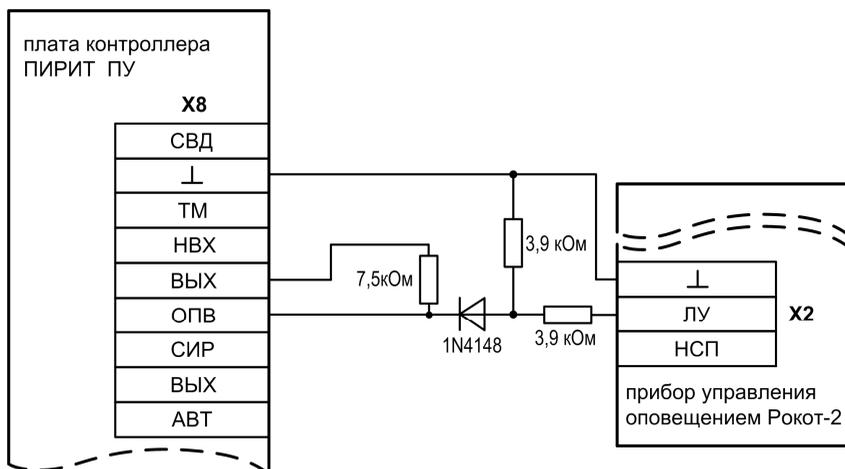
**Рис. 8** Подключение прибора речевого оповещения РОКОТ-2
