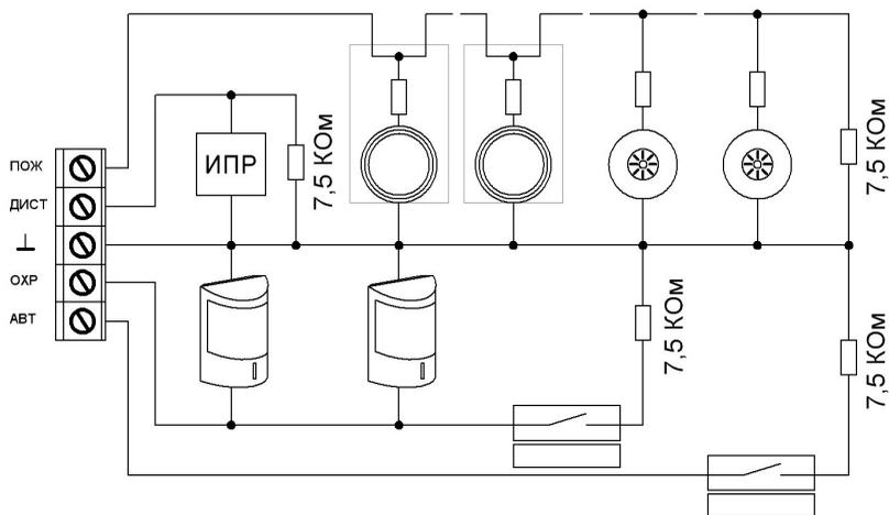
Рис. 3 Схема подключений ШС к «ПИРИТ ПУ»
