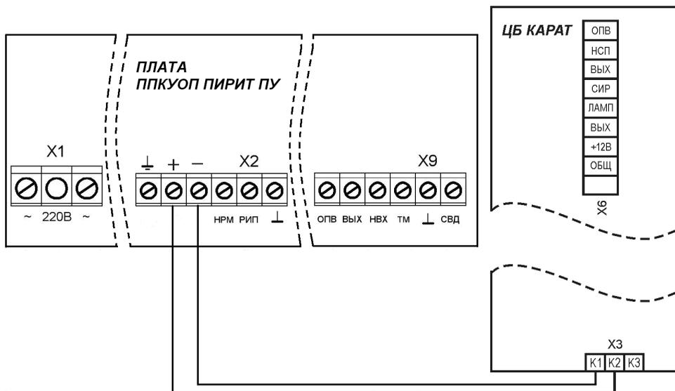
Рис. 10 Подключение ПИРИТ ПУ к линии связи КАРАТ
