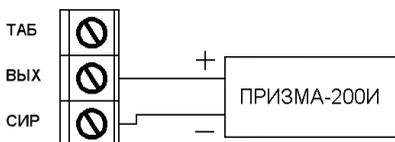
**Рис. 6** Схема подключения оповещателя «ПРИЗМА-200И» к «ПИРИТ ПУ»
