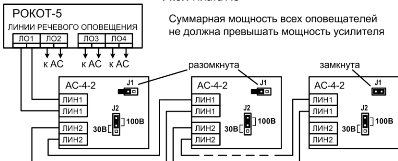
Рис.2 Схема подключения АС к «РОКОТ-5 ПУО-100» и «РОКОТ-5 УМ-100»
