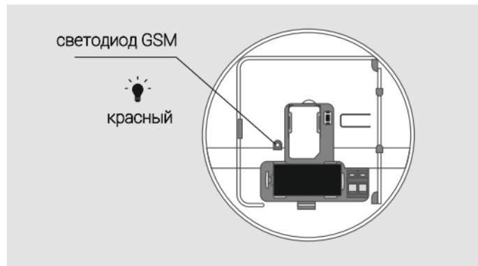
По окончании регистрации светодиод GSM будет мигать 1 раз в 4 секунды и прозвучит тройной звуковой сигнал.
