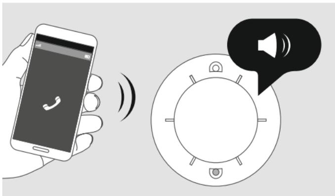
**Внимание!** В режиме программирования, в течение 40 секунд, извещатель ожидает входящие звонки (каждый принятый звонок продлевает ожидание ещё на 40 секунд), после чего автоматически выйдет из режима. Если Вы не успели записать все номера, вставьте защитную пластину в контакт батареи питания, подождите 2 минуты, снова включите питание, дождитесь тройного звукового сигнала и продолжите настройку.
