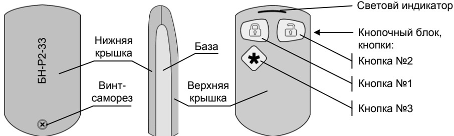
Рис.3 Конструкция брелока. Общий вид
