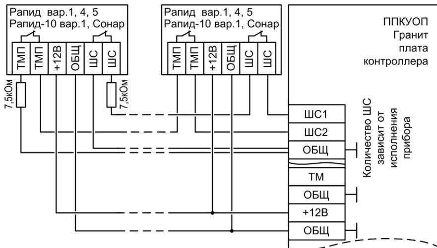
**Рис.А3** Схема подключения охранных извещателей Рapid вар.1,4,5, Рapid-10 вар.1, Сонар (тампер подключён к отдельному ШС)
