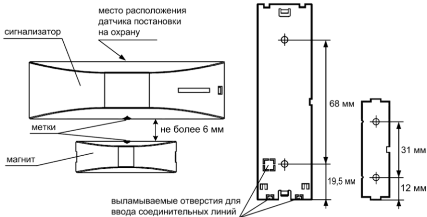
Рис.9 Схема установки, установочные и присоединительные размеры
