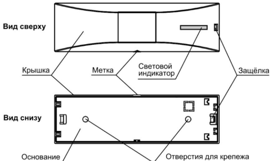
Рис.1 Конструкция сигнализатора. Вид сверху и снизу
