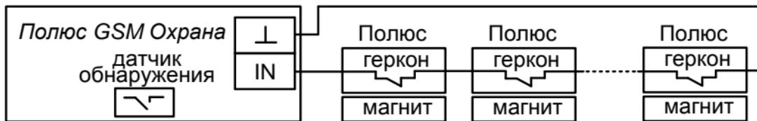
**Рис.6б** Схема подключения внешних датчиков.
