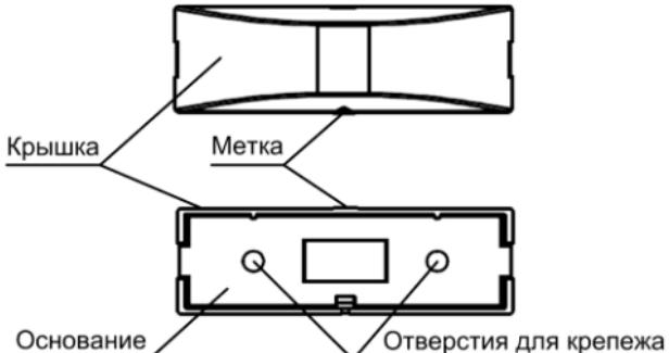
Рис.3 Конструкция магнита
