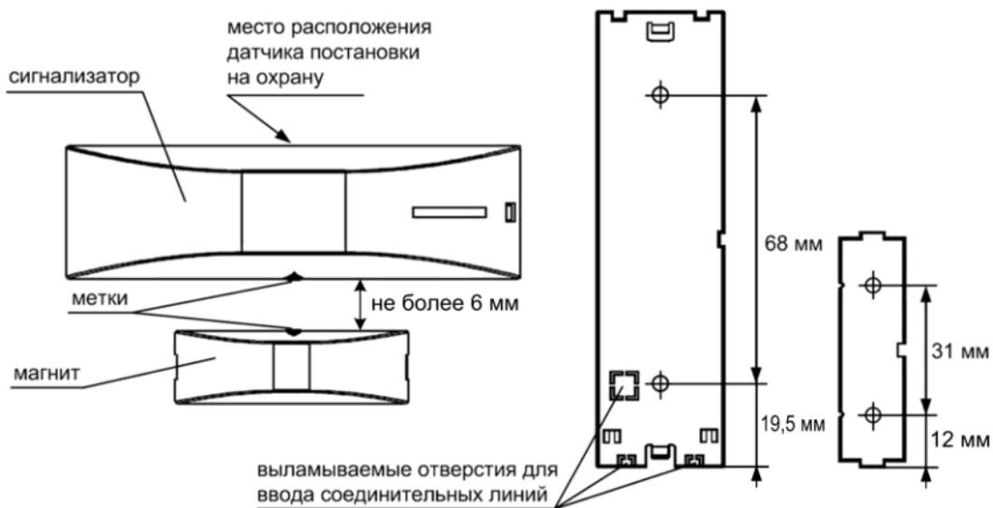
Рис.9 Схема установки, установочные и присоединительные размеры
