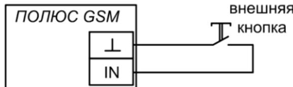
**Рис.10** Схема подключения внешней кнопки
