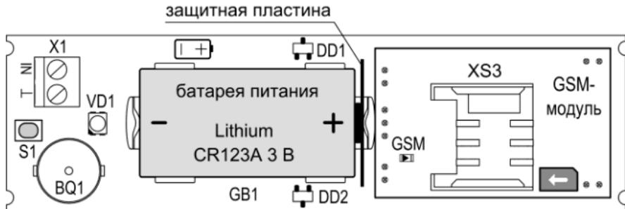
**Рис.2** Внешний вид платы контроллера и GSM-модуля
