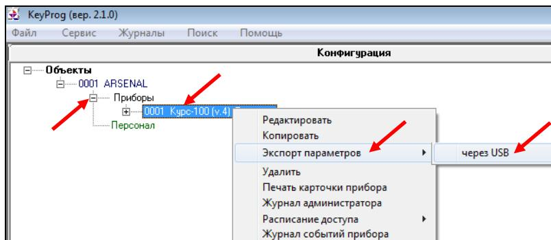
После экспорта параметров последовательно замкните перемычки J2 и J1 на плате, через 2-3 секунды отключите питание прибора и USB-кабель. Турникет готов к установке на объект.
