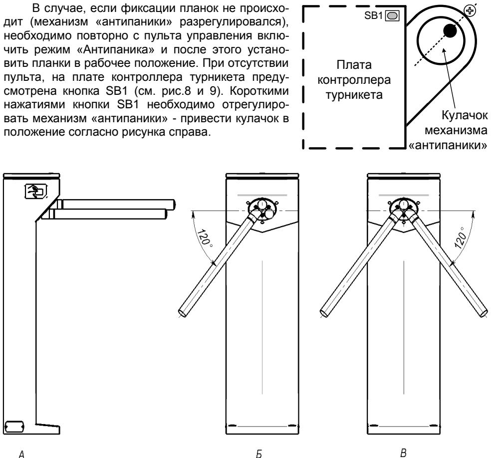
**Рис.4 Установка преграждающих планок в исходное рабочее положение**
