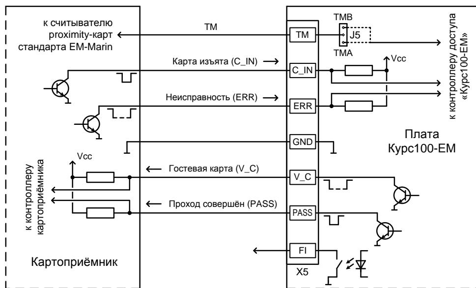
**Рис.5** Схема подключения картоприёмника к плате «Курс100-ЕМ» турникета
