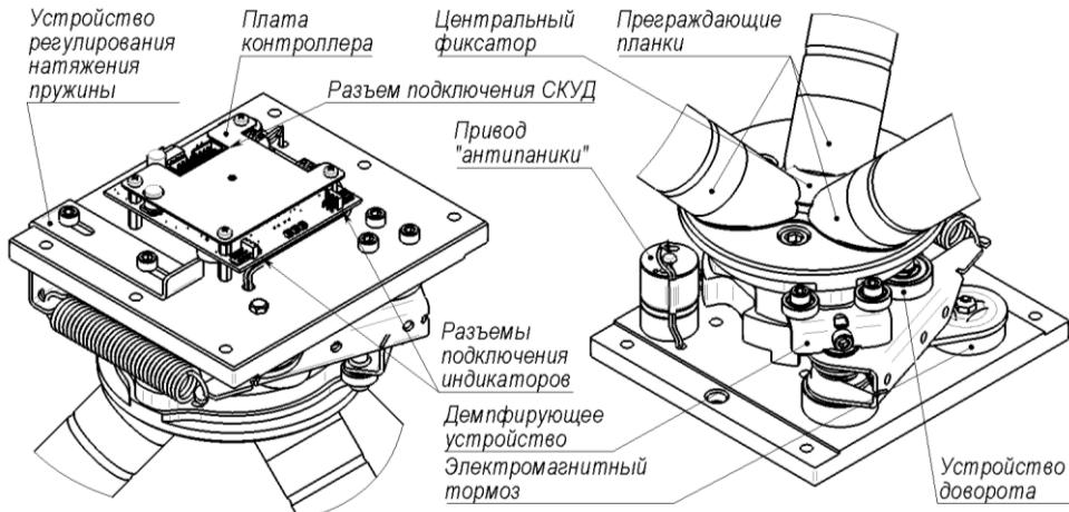
**Рис.6 Механизм турникета (вид верхней и нижней части).**
