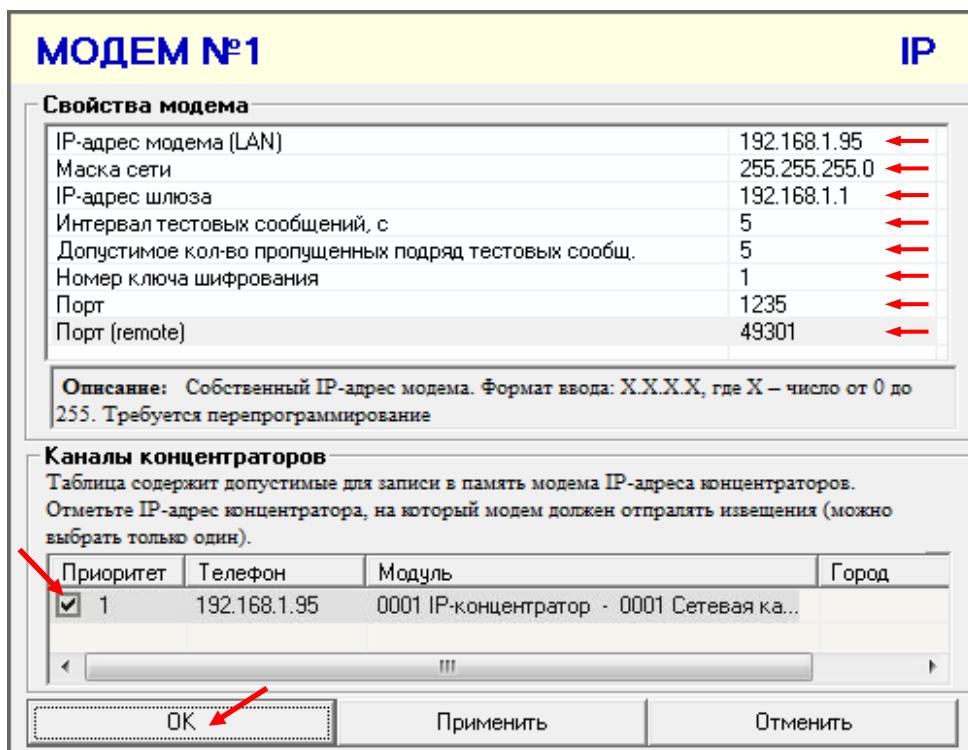
После создания прибора и настройки IP-модема в «АРМ администратора системы “Лавина”», необходимо загрузить конфигурацию (осуществить экспорт параметров) в контроллер доступа «Курс100-ЕМ» через USB-порт.
