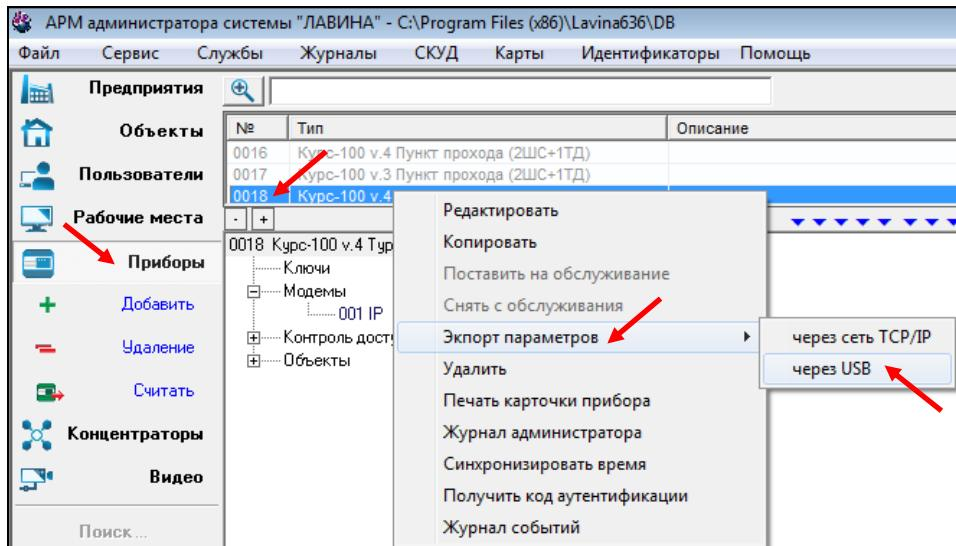
После экспорта параметров последовательно замкните перемычки J2 и J1 на плате, через 2-3 секунды отключите питание прибора и USB-кабель. Турникет готов к установке на объект.
