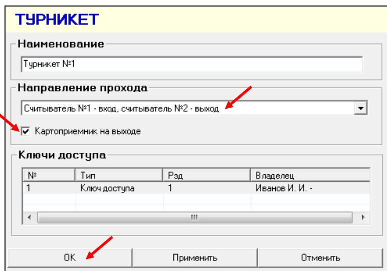
**ВНИМАНИЕ!** Если при указании направления прохода выбрано: «Считыватель №1 – вход, считыватель №2 – выход», то картоприёмник должен быть подключен вместо считывателя «В» турнicketа, а перемычка J5 на плате «Курс100-EM» должна быть установлена на трёхконтактный разъём в положение «TMB».
