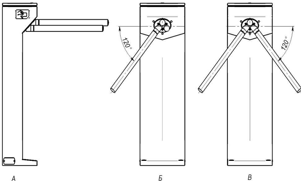
**Рис.4** Установка преграждающих планок в исходное рабочее положение
