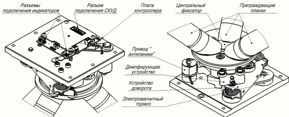
**Рис.6** Механизм турникета (вид верхней и нижней части).
